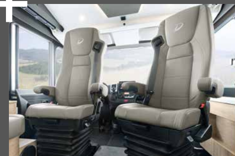
Ancora più comfort di viaggio: sedili a sospensione pneumatica SKA con riscaldamento e ventilazione compresi (optional sui motorhome)
