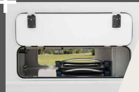
Protetto dal gelo: doppio pavimento riscaldato con molto spazio di stivaggio
