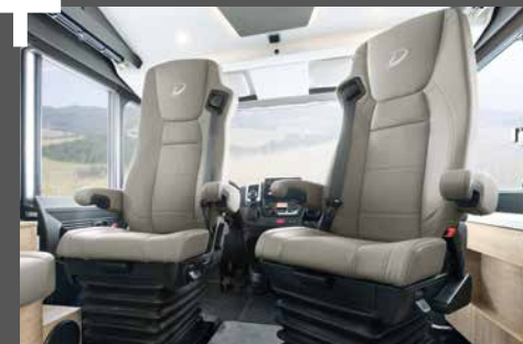
Ancora più comfort di viaggio: sedili a sospensione pneumatica SKA con riscaldamento e ventilazione compresi (optional negli integrali)
